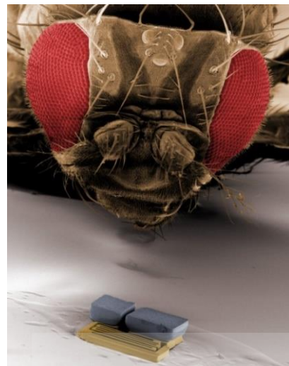
Figur 1: MagMite-Roboter, hergestellt durch Galvanisierung. Der Roboter wird von externen oszillierenden Feldern angetrieben. Er ist in der Lage, verschiedene Aufgaben auszuführen, wie z.B. das Bewegen kleiner Lasten und das Navigieren auf komplexen Wegen.
